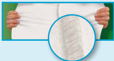
Structure des coutures de Tyvek® Classic Xpert
