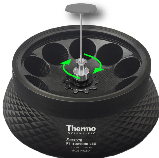
Figure III-3 : Serrer le rotor sur l'arbre d'entraînement, par ex. HAEMAFlex 12
