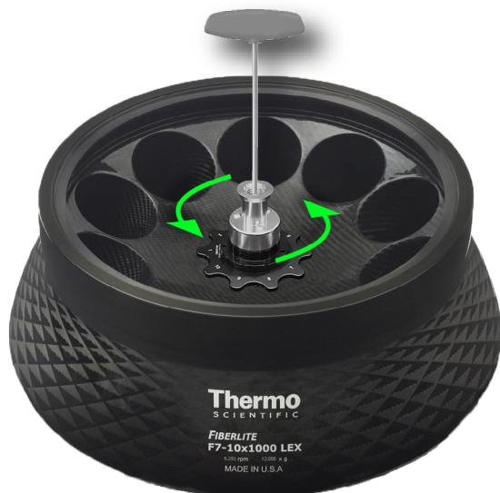
Figure III-12 : Dégager la vis de verrouillage du rotor de l'arbre d'entraînement
