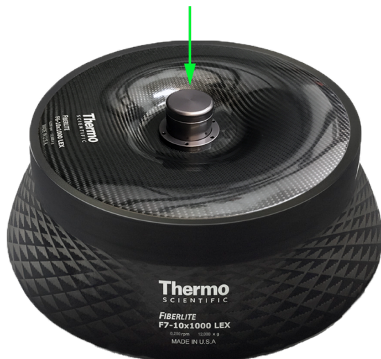
Figure III-6 : Placer le couvercle de rotor sur le corps de rotor
