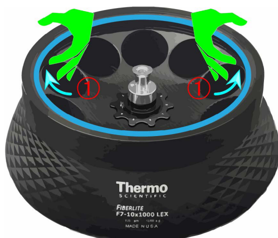
Figure III-2 : Montage du rotor
