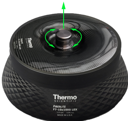
Slika III–11: Uklonite poklopac rotora sa tela rotora
