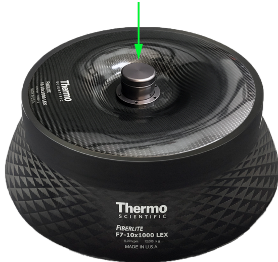
Slika III-6: Stavite poklopac rotora na telo rotora
