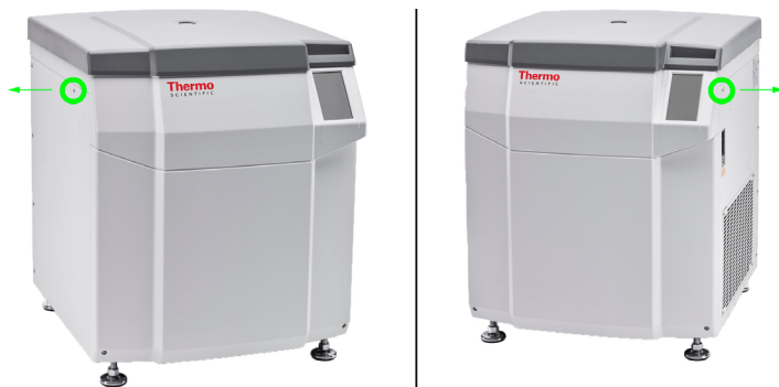
Slika V-2: Položaj mehaničkog otključavanja vrata u vanrednim situacijama
