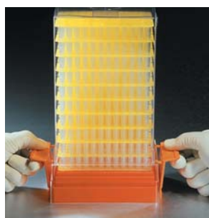
Système de chargement de pointes
