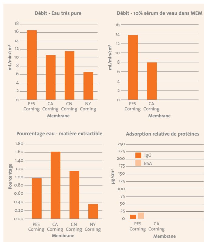
Figure 1. Caractéristiques importantes pour les performances des membranes filtrantes Corning®.
