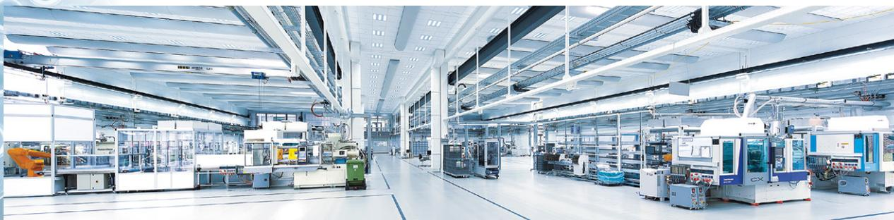
Les articles BRAND à usage unique destinés au domaine Life Science sont fabriqués à l'aide d'une technologie de prévention de la contamination des plus modernes et dans l'une des plus grandes salles blanches pour la production d'articles de laboratoire à usage unique au monde. Conjuguée à une régulation précise des conditions ambiantes, la surveillance continue de la salle blanche permet d'assurer des températures constantes dans l'ensemble de la zone de
