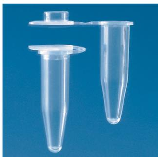
Les tubes PCR 0,2 ml et 0,5 ml avec capuchon attaché sont appropriés pour l'utilisation dans les thermocycleurs munis de couvercles chauffants de la plupart des fabricants. La fermeture optimale des capuchons attachés permet de réduire au minimum la perte de
