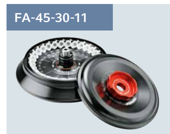
Rotor pour 30 microtubes 1,5/2 mL avec couvercle anti-aérosols pour la centrifugation sûre d'échantillons dangereux. Vitesse max. : 20 800 x g (14 000 rpm).
