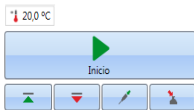
Figura 18. De izquierda a derecha debajo de Inicio: Introducir placa, Extraer placa, Cebiar dispensadores, Vaciar dispensadores.
