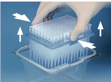
Comprimer l'outil de transfert sur le côté long, le maintenir comprimé et soulever la plaque support. Veiller à ce que les languettes de maintien de l'outil de transfert soient correctement positionnées.
