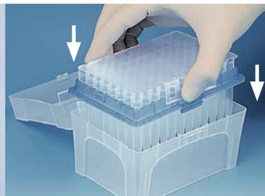
Mettre en place la plaque support remplie dans la TipBox préalablement stérilisée en procédant verticalement par le haut et l'encliqueter.
