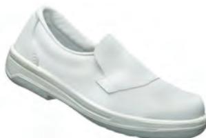
Embout coqué métallique 200 joules, semelle intermédiaire perforée, semelle extérieure en polyuréthane blanc double densité injecté.
