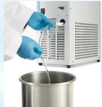
Le tube de remplissage souple installé sur le panneau frontal permet de vidanger rapidement l'unité.
