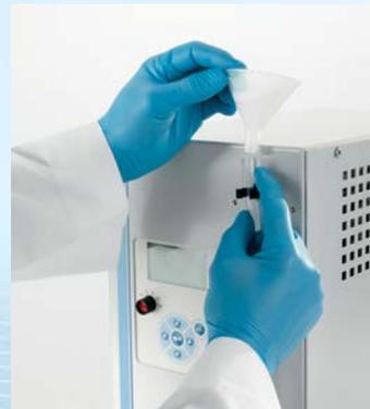
Emplacement du tube à l'avant de l'unité pour obtenir une indication rapide du niveau de liquide.
