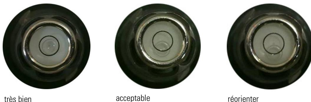
**Figure 6.** Position de la bulle d'air dans le niveau à bulle
