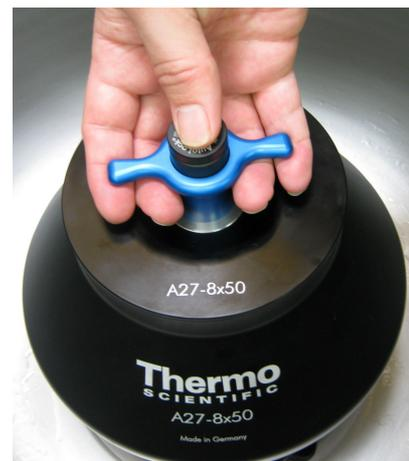
Figure 14. Position des mains pour le démontage du rotor
