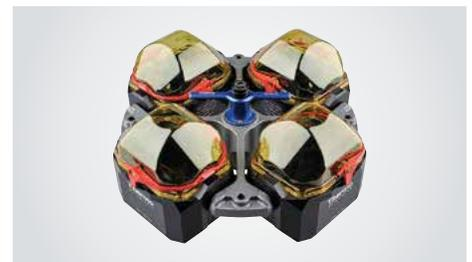
Le rotor Thermo Scientific BIOFlex HC prend en charge jusqu'à 40 tubes coniques de 50 ml, 96 tubes coniques de 15 ml, 24 microplaques et plus de 35 autres types de tubes avec des dizaines d'adaptateurs pour une plus grande flexibilité de recherche.
