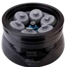
**Rotor Fiberlite F9-6x1000 LEX :** bénéficie de la conception plus légère LEX et prend en charge 6 flacons de 1 litre avec une grande polyvalence de tubes, des microtubes de 1,5 ml aux flacons de 500 ml, grâce aux nombreux adaptateurs.
