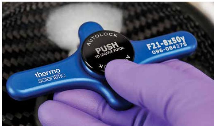
Installation et retrait du rotor, de façon sécurisée et sûre, en seulement 3 secondes
