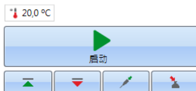
图 18. “开始”按钮下从左到右依次为：进板、出板、分液器充液、分液器排空。
