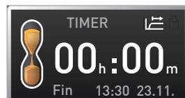
Pour désactiver le programmeur, appuyer sur la touche de validation pour appeler de nouveau l'affichage du programmeur, ramener la durée du cycle à l'aide du bouton rotateur jusqu'à l'affichage --:-- et accepter avec la touche de validation.
