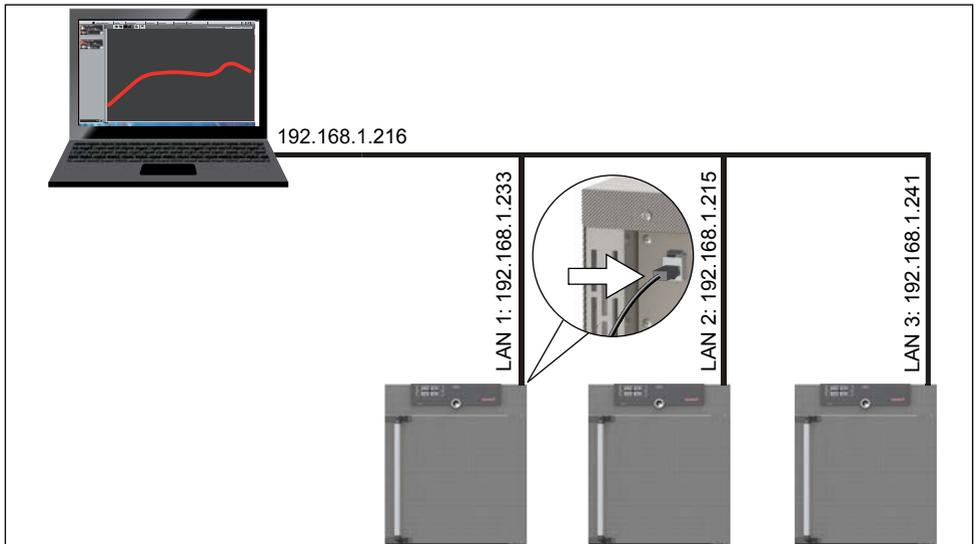
III. 21 Utilisation de plusieurs appareils dans un réseau (exemple schématique)
