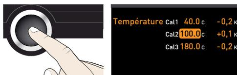
3. À l'aide du bouton rotateur, régler la température d'étalonnage Cal2 sur 120 °C.
