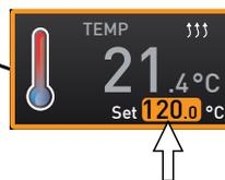
8. Attendre que l'appareil atteigne la température de consigne et affiche 120 °C. Le thermomètre étalon relève une température de 122,6 °C.
