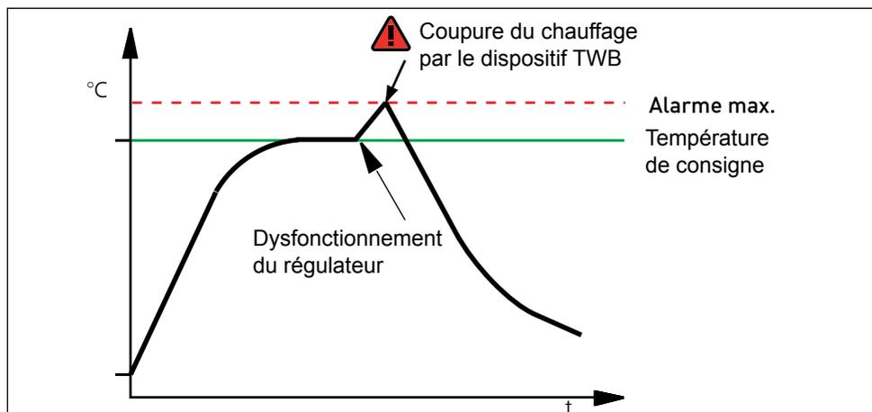
Ill. 17 Schéma du fonctionnement du dispositif de sécurité thermique TWB (uniquement si l'appareil est équipé d'une deuxième sonde de température, option A6)
