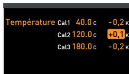
5. Régler le correctif d'étalonnage sur 0,0 K et enregistrer ce réglage en appuyant sur la touche de validation.
