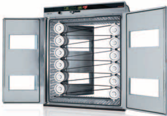
Four de fabrication à transfert en ligne (entrée/sortie de bande latérale)
