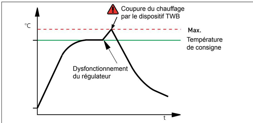
III. 19 Schéma du fonctionnement du dispositif de sécurité thermique TWB
