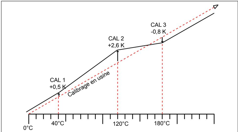
Ill. 27 Schéma illustrant l'étalonnage de la température
