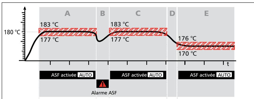
Ill. 20 Schéma du fonctionnement du dispositif de sécurité ASF
