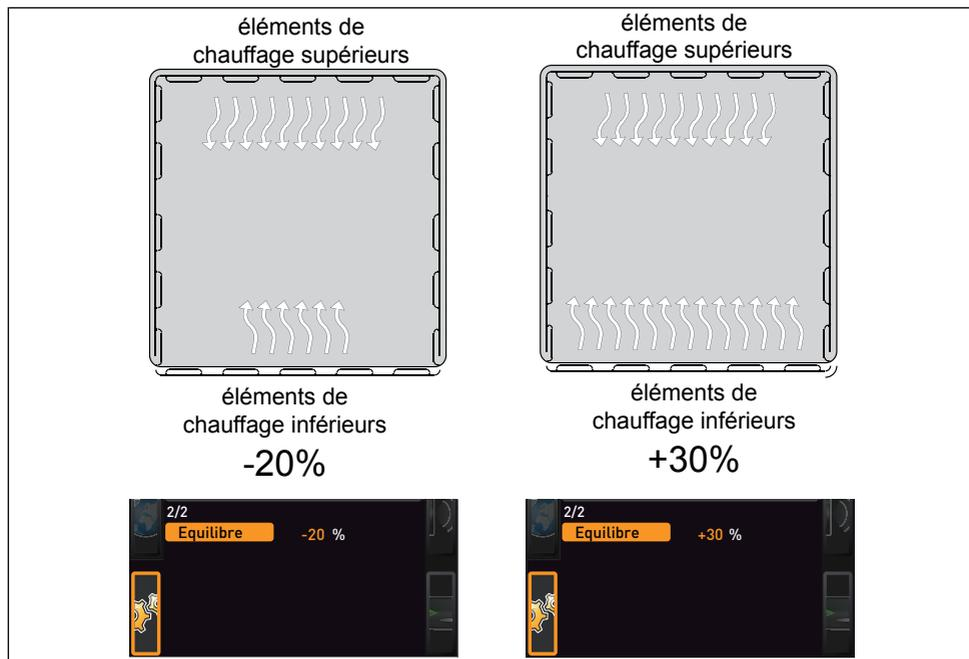
Ill. 25 Distribution de la capacité de chauffe (exemple) : Le réglage de -20 % (à gauche) signifie que les éléments de chauffage inférieurs chauffent avec une puissance de 20 % inférieure aux éléments de chauffage supérieurs. Le réglage de +30 % (à droite) signifie que les éléments de chauffage inférieurs chauffent avec une puissance de 30 % supérieure aux éléments de chauffage supérieurs. Le réglage 0 % rétablit la distribution de la capacité de chauffe d'usine.
