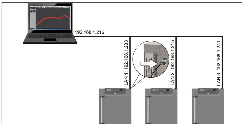
Ill. 23 Utilisation de plusieurs appareils dans un réseau (exemple schématique)
