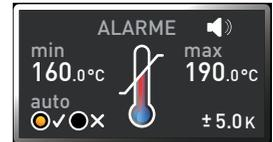
Dès que le dispositif de sécurité thermique est déclenché, cet événement est signalé dans l'affichage de la température par la température effective indiquée en rouge et par un symbole d'alarme ⚠ (ill. 16).
