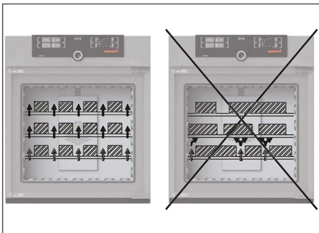
Ill. 14 Mise en place correcte de l'élément de chargement
