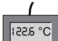
9. Régler le correctif d'étalonnage Cal2 dans CALIB sur +2,6 K (valeur effective déduite de la valeur de consigne) et enregistrer ce réglage en appuyant sur la touche de validation.
