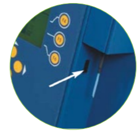
Détecteur infrarouge, déclenche automatiquement l'aspiration de l'échantillon
