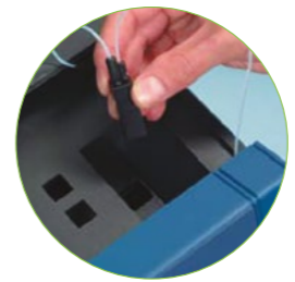
Utilisation de la cuve à circulation 30 µl ou utilisation cuve à cuve (cuve plastique jetable ou cuve verre)
