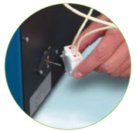
Accès rapide à la pompe péristaltique de prélèvement de l'échantillon située à l'arrière du BASIC
